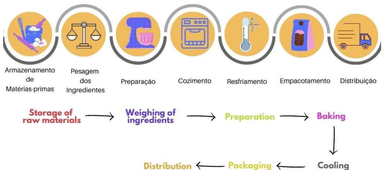
Figura 1: Fluxograma com as etapas de fabricação dos biscoitos
