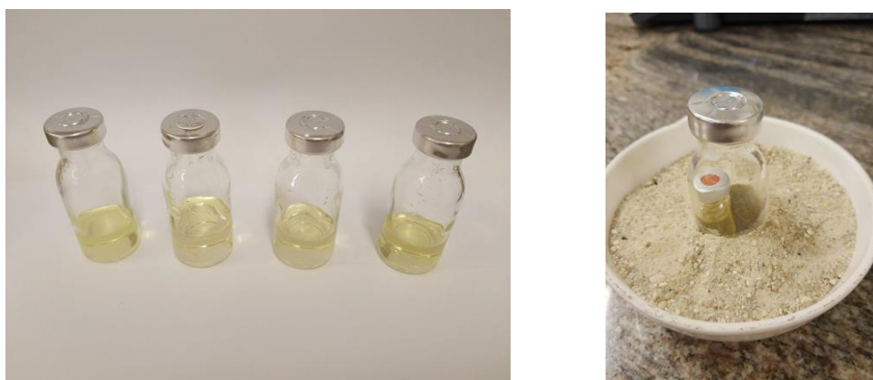
Figura 6 - Frascos com óleo de peixe, em ambiente inerte com nitrogênio, lacrados, acondicionados em cápsulas de porcelana em areia
