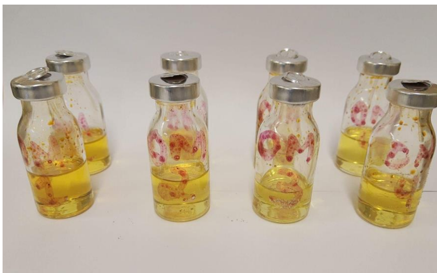
Figura 7 - Amostras OP 48, OP 49, OP 50 e OP 51 submetidas a 200°C por 6h, em forno Mufla
