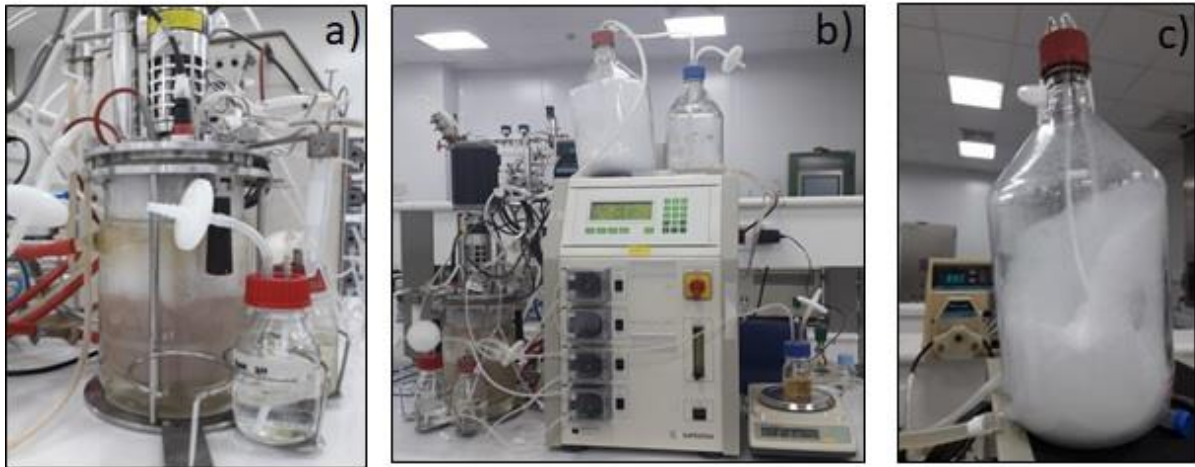
Figura 22: Cultivo de Bacillus subtilis ATCC21332 em biorreator Biostat B para a produção de surfactina (a e b). A Figura c destaca o frasco de coleta de espuma.
