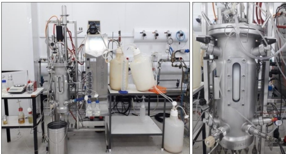
Figura 25: Cultivo de Bacillus subtilis ATCC 21332 em biorreator Biostat Cplus e frascos de coleta de espuma para a produção de surfactina
