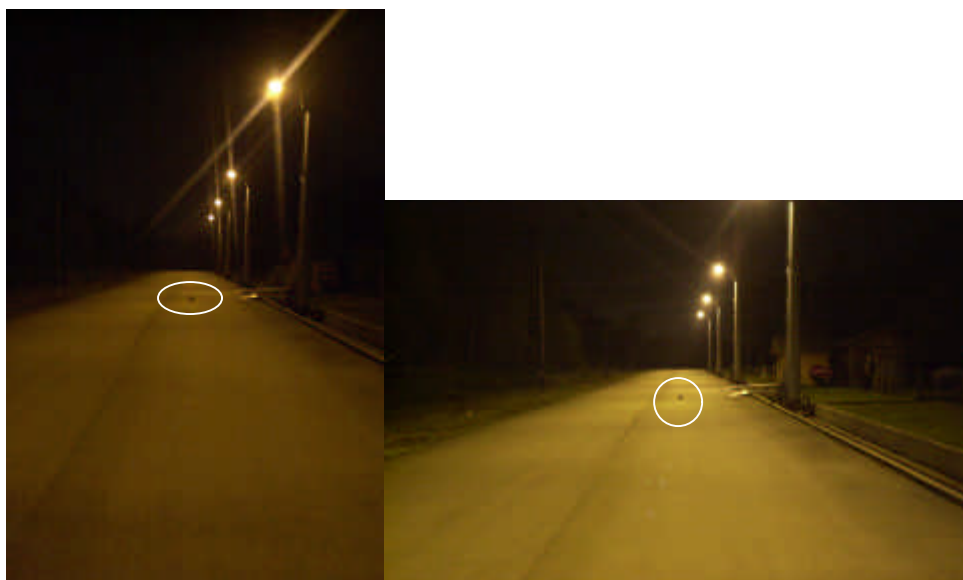
Figura 2.46 – Vistas da via (e alvo: ponto escuro no interior do círculo branco estabelecido) onde a segunda parte do experimento foi realizada, na França. À esquerda, o sistema com 50 % do fluxo luminoso e à direita com 100 %. Fotos cedidas por Alexis Bacelar.
