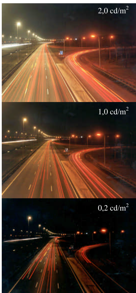
Figura 2.29 – O projeto em rodovia holandesa onde foi realizado experimento sobre a variação do fluxo luminoso. Fonte: ( Dynamic public lighting project )
