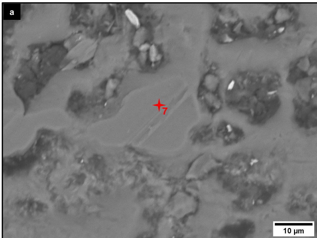
Figura 20 - Ponto 7 da região esbranquiçada. (a) Imagem de elétrons retroespalhados (MEV – ERE). (b) Espectro de energia dispersiva (MEV-EDS).
