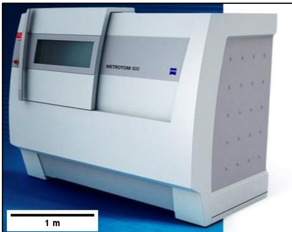
Figura 7 - Tomógrafo industrial utilizado na avaliação dos cordões de solda.
