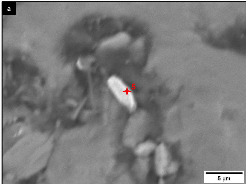
Figura 18 - Ponto 5 da região esbranquiçada. (a) Imagem de elétrons retroespalhados (MEV – ERE). (b) Espectro de energia dispersiva (MEV-EDS).
