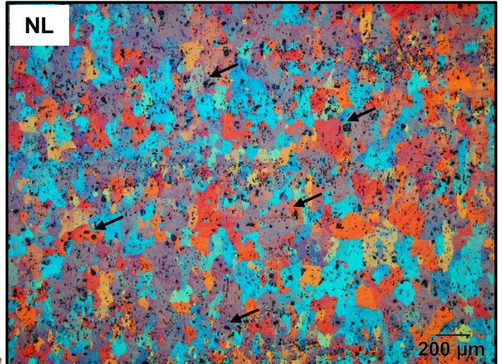
Figura 33 - Microestrutura do metal base obtida por microscopia óptica com luz polarizada. Ataque eletrolítico. Aumento: 50X.
