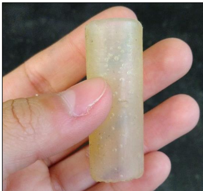
Figura 16: Molde de borracha para inserir os pós magnéticos após secagem e levar para a compactação.
