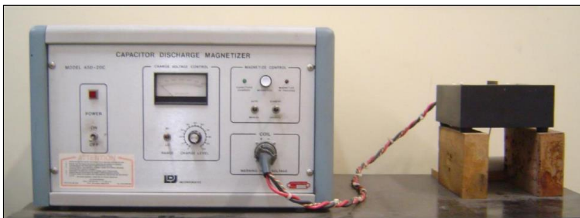
Figura 17: Magnetizador, modelo LDJ 450-20C.
