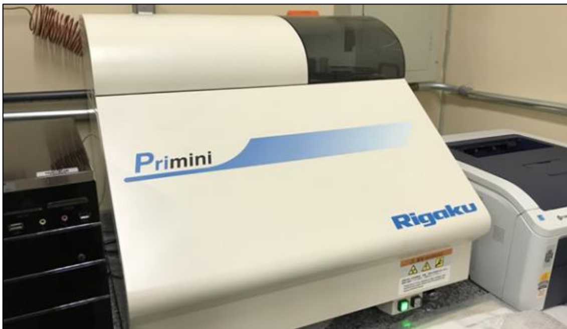
Figura 20: Espectrômetro de raios X, modelo Rigaku Primini.
