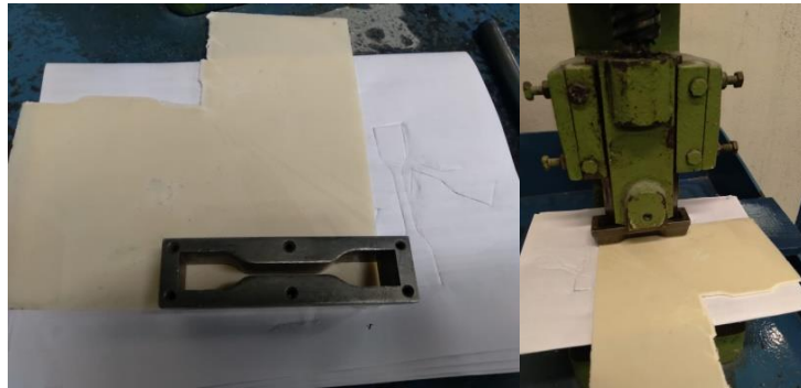
FIGURA 19 – Fabricação dos corpos de prova
