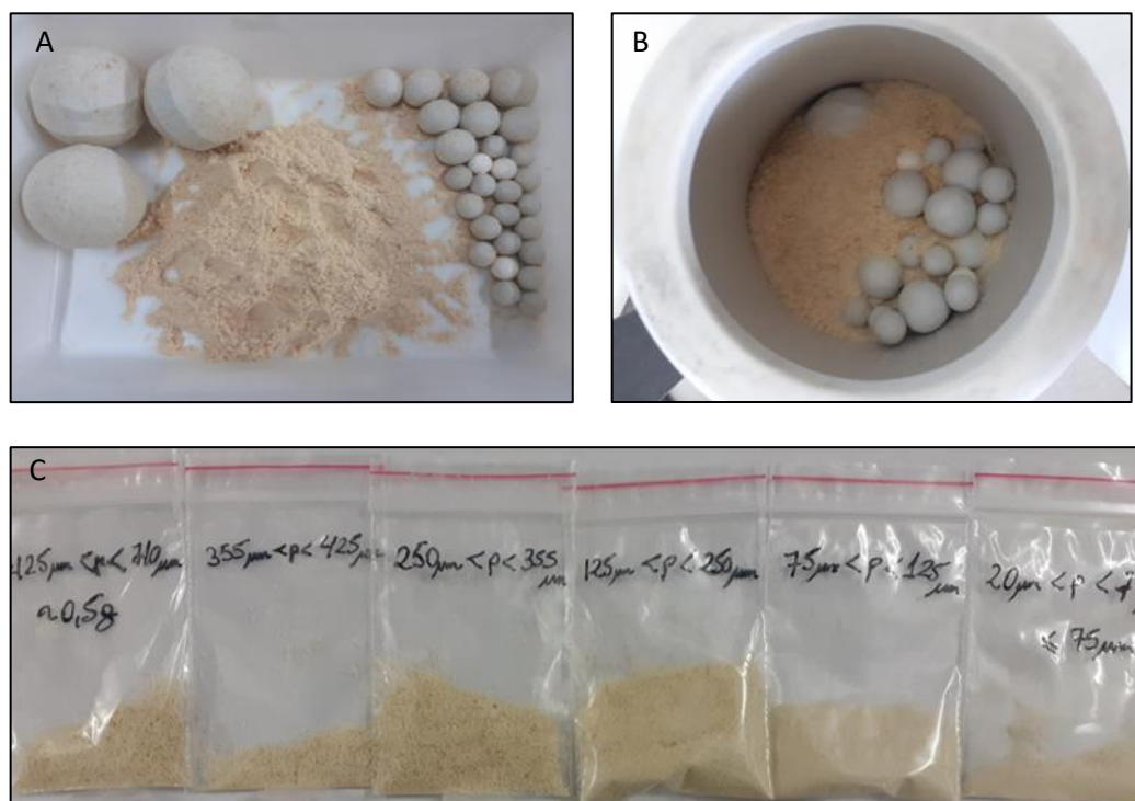
Figura 11 – (A) BCA depois de trituração no liquidificador industrial. (B) BCA após triturador de bolas; (C) BCA com diferentes diâmetros de partículas após peneiração molecular
