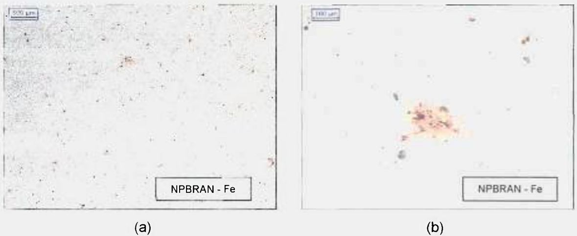
Figura 5.24: Análise de imagens da amostra NPBRAN manchada com óxido de ferro e lavada em água quente.
