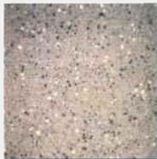
Figura 2.30: Porcelanato tipo macrogranito.
