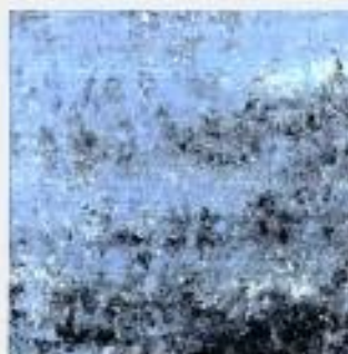
Figura 2.28: Porcelanato tipo variegado ou matizado.
