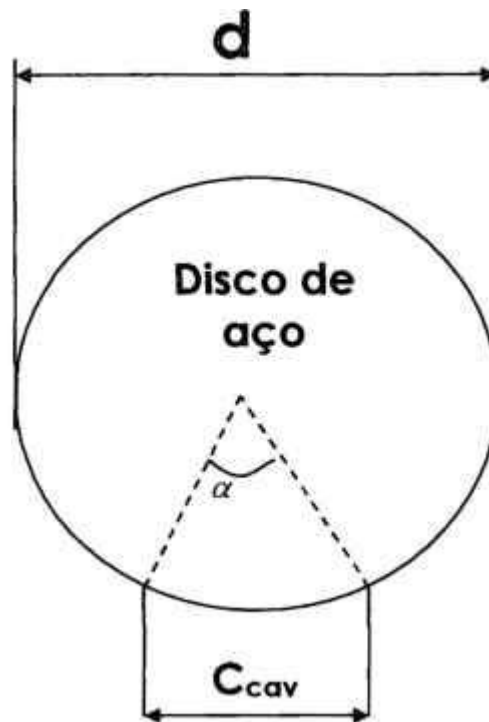
Figura 4.9: Medida do comprimento da cavidade após o ensaio de abrasão profunda 59
