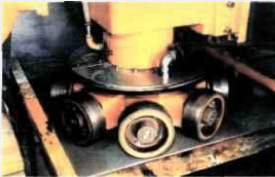
Figura 2.18: Polimento em equipamento com sistema rotativo contendo de 6 a 8 rebolos abrasivos à base de SiC 16 .
