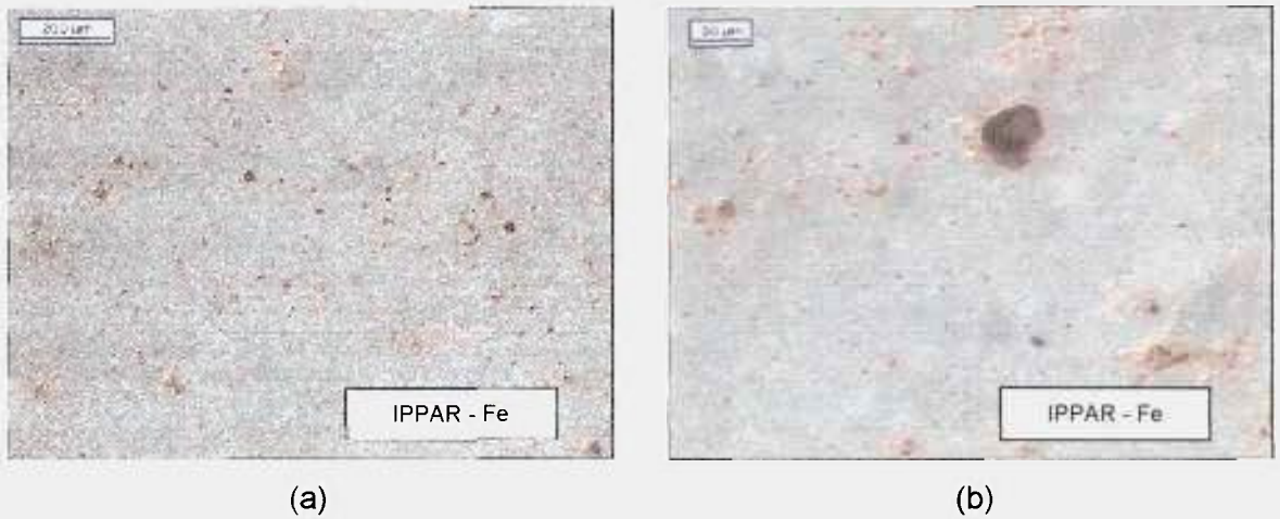
Figura 5.23: Análise de imagens da amostra IPPAR manchada com óxido de ferro e lavada em água quente.
