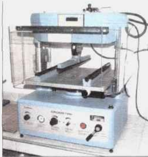
Figura 4.3: Ilustração do crômetro utilizado para medida da carga de ruptura dos produtos em estudo.
