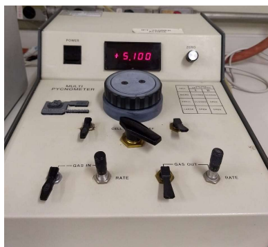
Figura 11. Picnômetro de hélio
