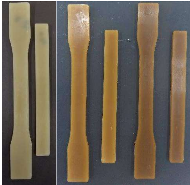
Figura 49. Corpos de prova da amostra dos nanocompósitos de haloisita pura com a concentração de 2 % (PA11/HNT 98/2) e submetida à duas (PA11/HNT 98/2 (2E)) e três extrusões (PA11/HNT 98/2 (3E)), da esquerda para direita, respectivamente
