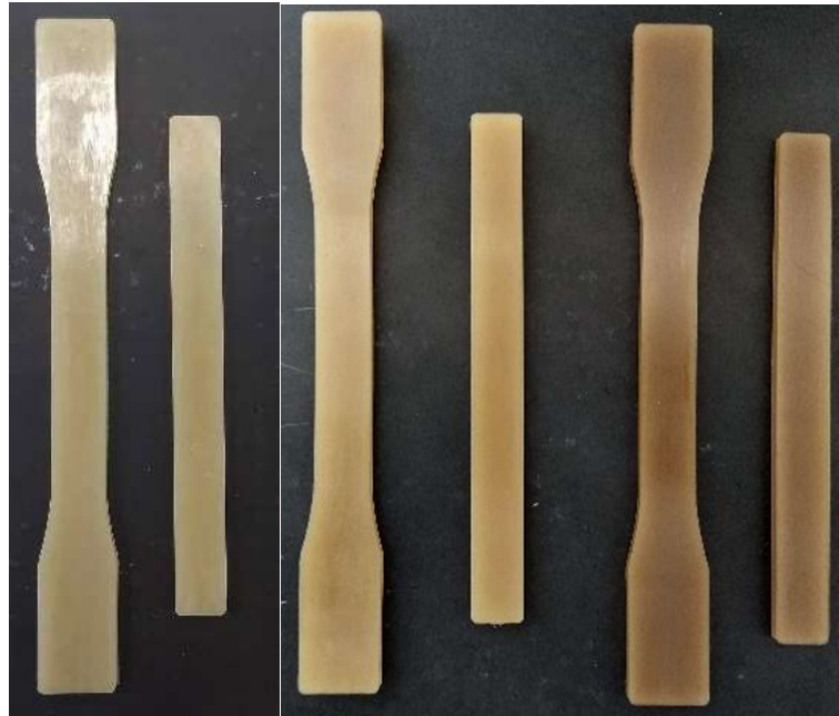
Figura 51. Corpos de prova dos nanocompósitos de haloisita modificada com MAPTS (50HM1:1) com a concentração de 2 % (PA11/50HM1:1 98/2) e submetida à duas (PA11/50HM1:1 98/2 (2E)) e três extrusões (PA11/50HM1:1 98/2 (3E)), da esquerda para direita, respectivamente
