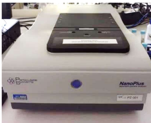
Figura 12. Analisador de tamanho de partícula e potencial zeta
