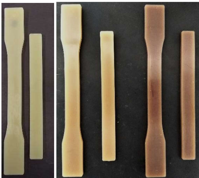
Figura 50. Corpos de prova dos nanocompósitos de haloisita modificada com EPB (90HE) com a concentração de 2 % (PA11/90HE 98/2) e submetida à duas (PA11/90HE 98/2 (2E)) e três extrusões (PA11/90HE 98/2 (3E)), da esquerda para direita, respectivamente
