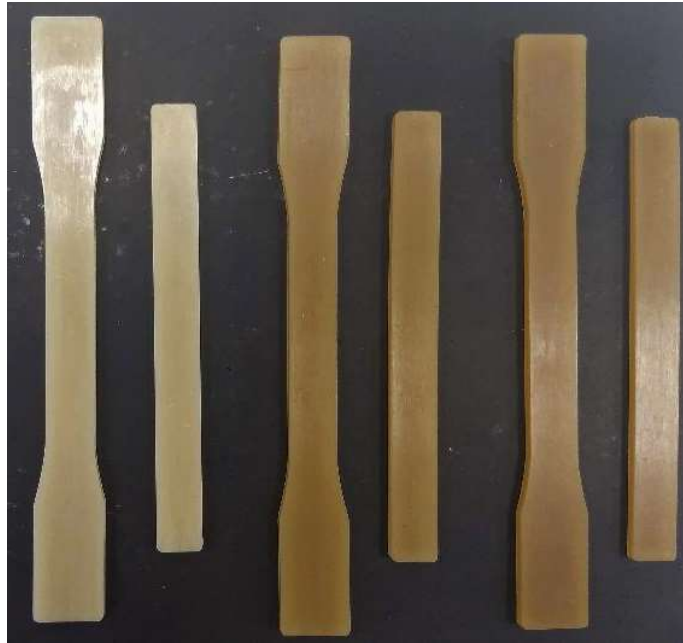
Figura 41. Corpos de prova dos nanocompósitos de haloisita modificada com MAPTS (50HM1:1) com as concentrações de 2 % (PA11/50HM1:1 98/2), 6 % (PA11/50HM1:1 94/6) e 10 % (PA11/50HM1:1 90/10) de 50HM1:1 da esquerda para a direita, respectivamente
