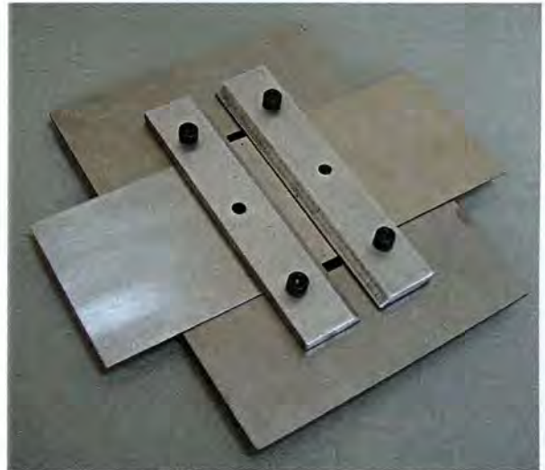
Figura 24 – Dispositivo de posicionamento e fixação para o experimento de solda laser dos corpos de prova de tração (dimensões em mm).
