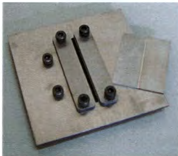
Figura 17 – Dispositivo de posicionamento e fixação para o experimento de solda laser.
