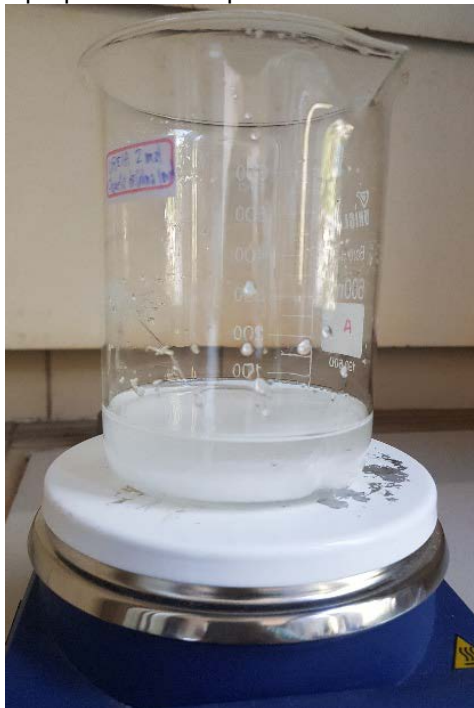
Figura 17 – Sólidos em preparo com temperatura de 90°C e em rotação de 400 rpm.
