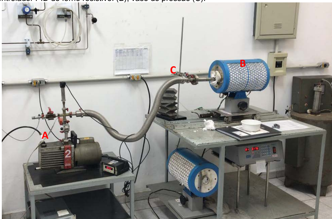
Figura 14 – Sistema de redução de óxido de grafeno constituído por: bomba mecânica (A), controlador PID do forno resistivo. (B), vaso de pressão (C).
