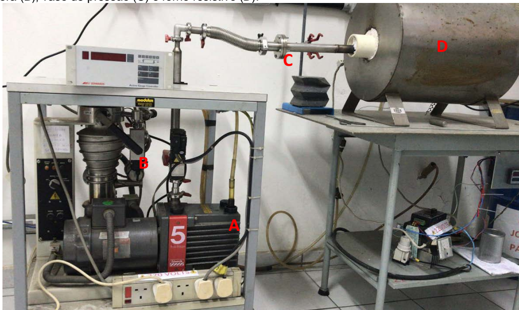
Figura 12 – Sistema de redução de óxido de grafeno constituído por: bomba mecânica (A), bomba difusora (B), vaso de pressão (C) e forno resistivo (D).
