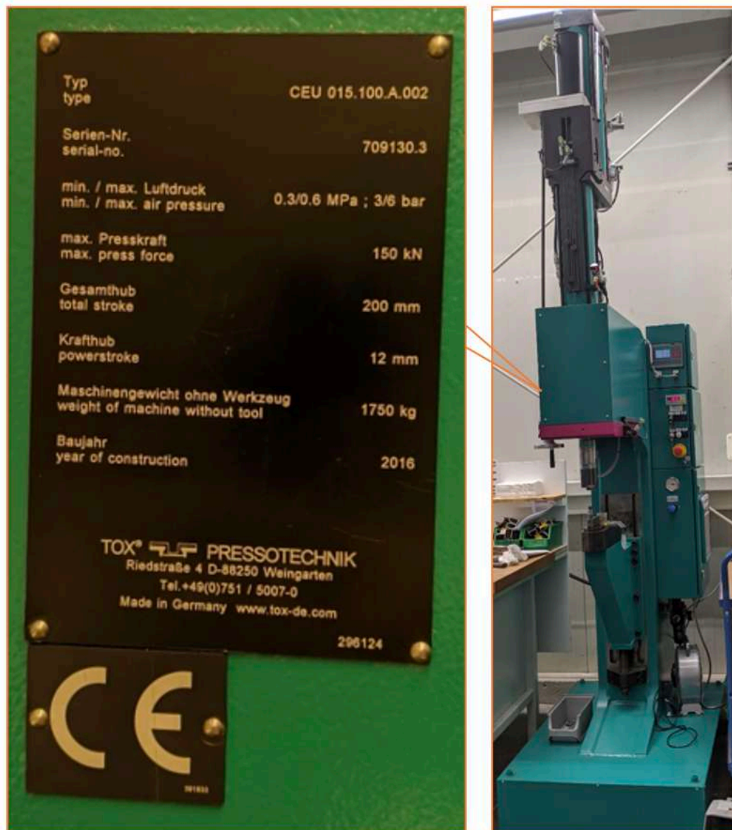
Figura 24 - Equipamento TOX CEU 015 com monitoramento de curso e forças aplicadas na prensagem e no prensa-chapas.
