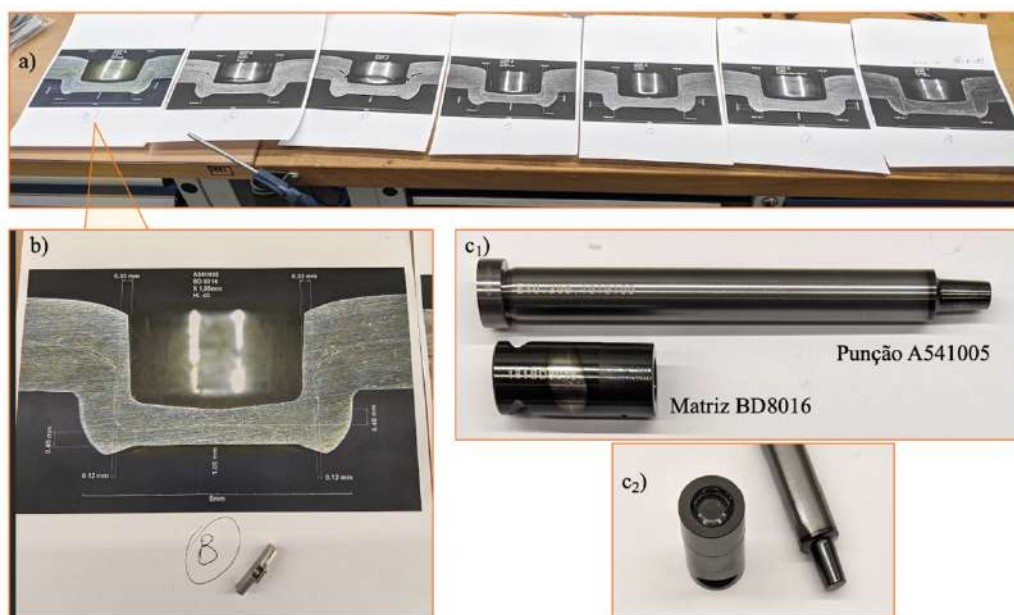
Figura 35 - DoE para a escolha do conjunto de punção e matriz (a); seção do clinch resultante dos parâmetros escolhidos (b); o conjunto de punção e matriz preconizados c_1 e c_2 .
