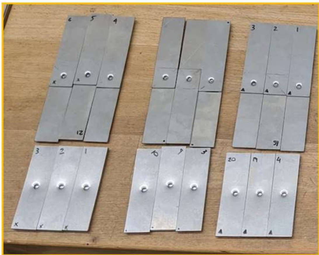
Figura 34 - Conjuntos montados para ensaio de resistência à tração por cisalhamento e destacamento clinchng .
