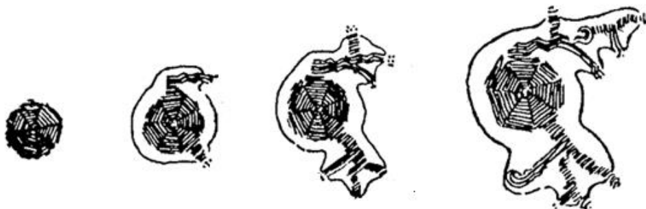
Figura 20 Representação da degeneração do nódulo de grafita
