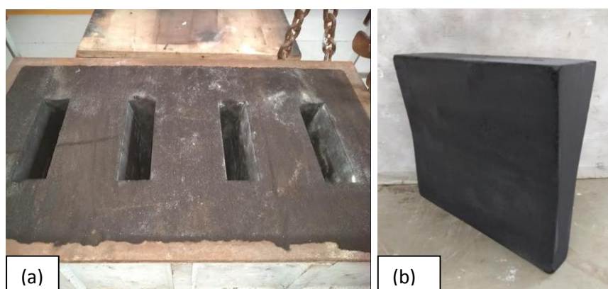
Figura 51 (a) Molde em areia para vazamento dos cp's, (b) Modelo em madeira dos cp's
