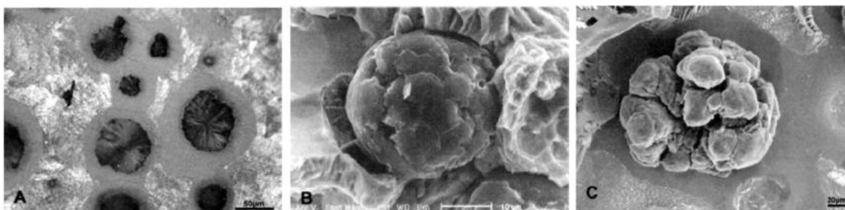
Figura 34 (a) Nódulos de grafita envolvidos por ferrita em matriz perlítica; (b) Nódulo em superfície de fratura; (c) Nódulo com grafita degenerada e cementita na parte superior esquerda
