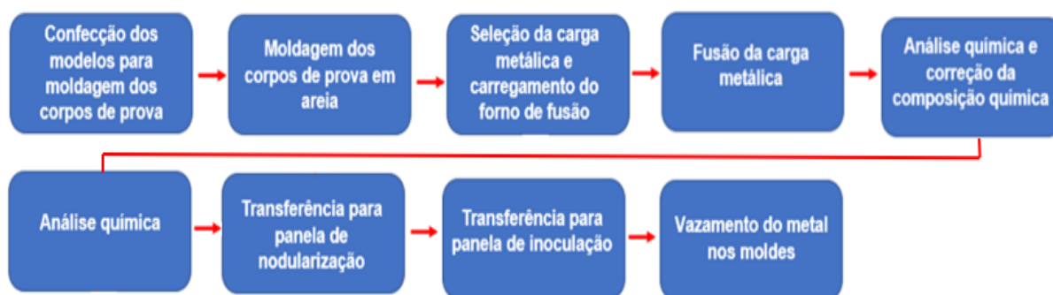
Figura 48 Fluxograma do processo de fundição dos corpos de prova
