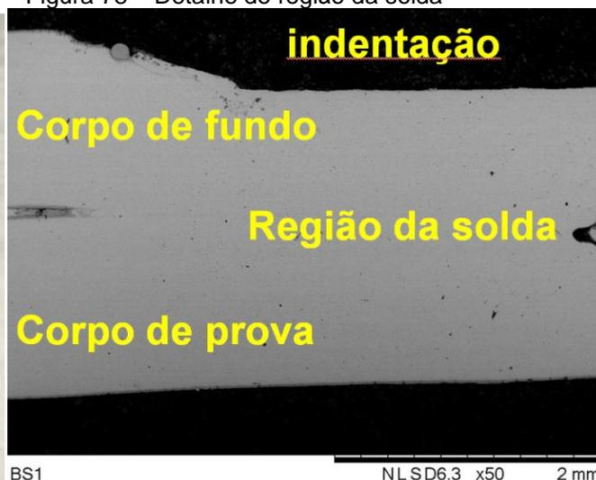
Figura 79 - Detalhe de região da solda
