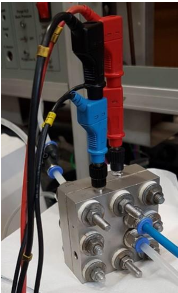
Figura 4 – Célula unitária de aço especialmente desenvolvida para aplicação como reator de síntese química.
