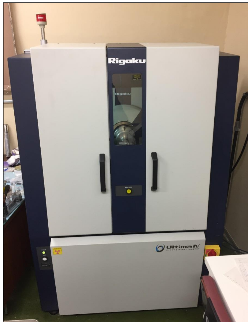
Figura 18 - Difratômetro no qual se baseou o desenvolvimento do trocador programável de amostras.
