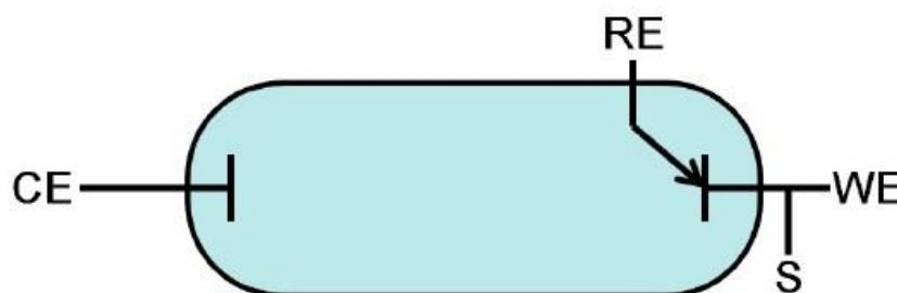
Figura 13 - Representação de um ensaio de EIE com três eletrodos. Eletrodo de trabalho(WE), Contra eletrodo(CE), eletrodo de referência (RE) e sinal elétrico aplicado ao eletrodo (S).
