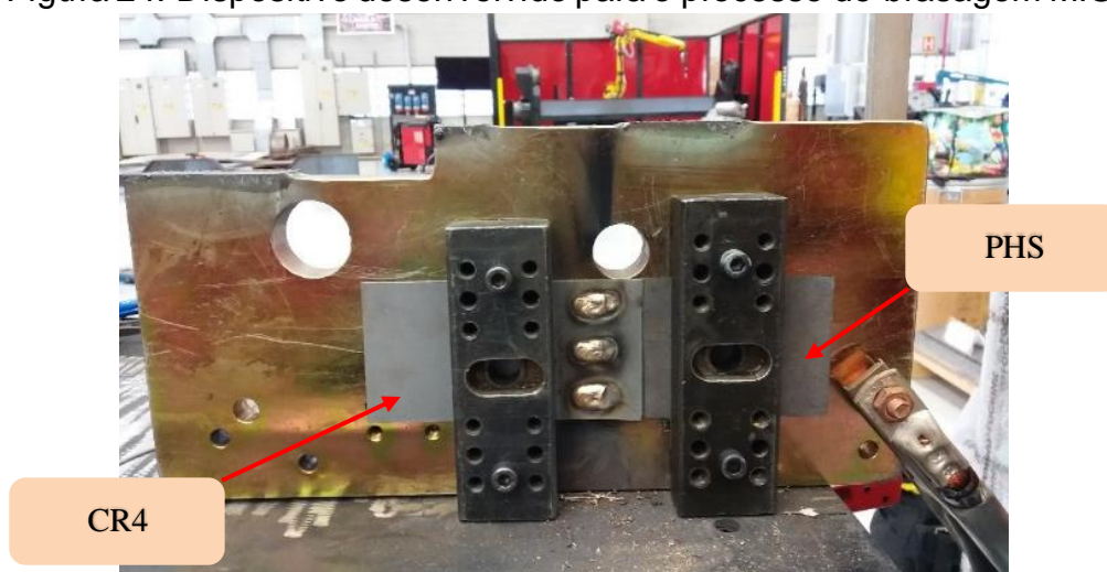
Figura 24: Dispositivo desenvolvido para o processo de brasagem MIG.
