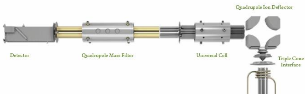
Figura 6 - Esquema do sistema de ICP-MS utilizado na detecção e quantificação dos EGPs .
