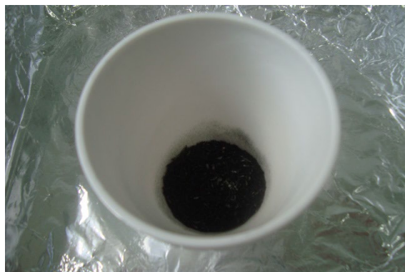
Figura 37 – BC após ensaio de teor de material volátil
