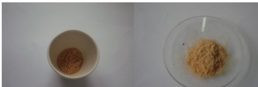
Figura 36 – BC após ensaio de teor de cinzas
