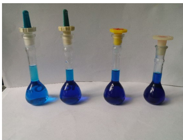
Figura 28 – Amostras de solução azul de metileno após a adsorção
