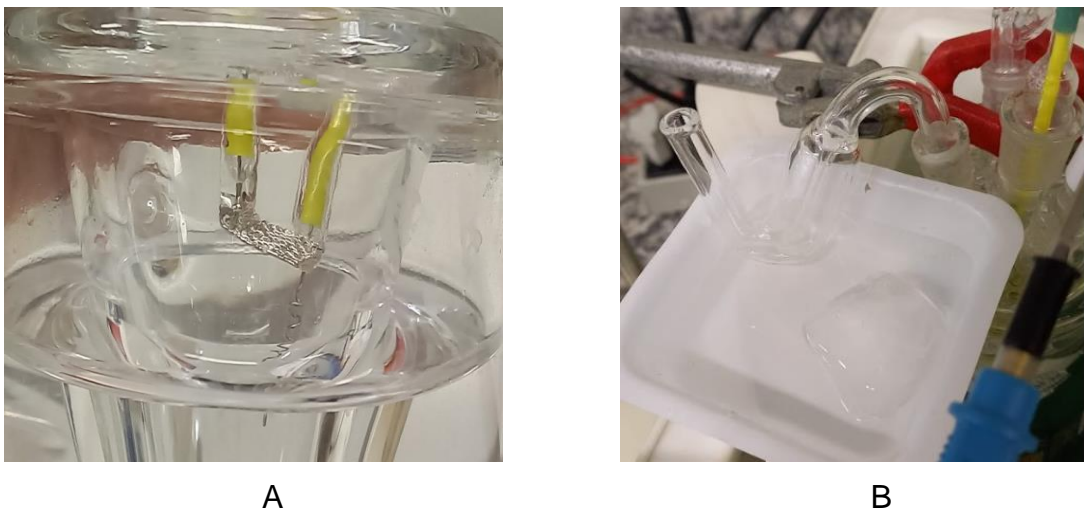
Figura 9 – Alterações realizadas na célula eletroquímica com o objetivo de aumentar a captura de iodo na temperatura de 60^\circ\text{C}
