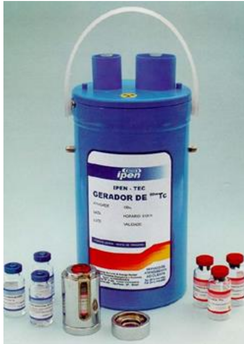
Figura 6 - Gerador de ^{99}\text{Mo}/^{99}\text{Tc}
