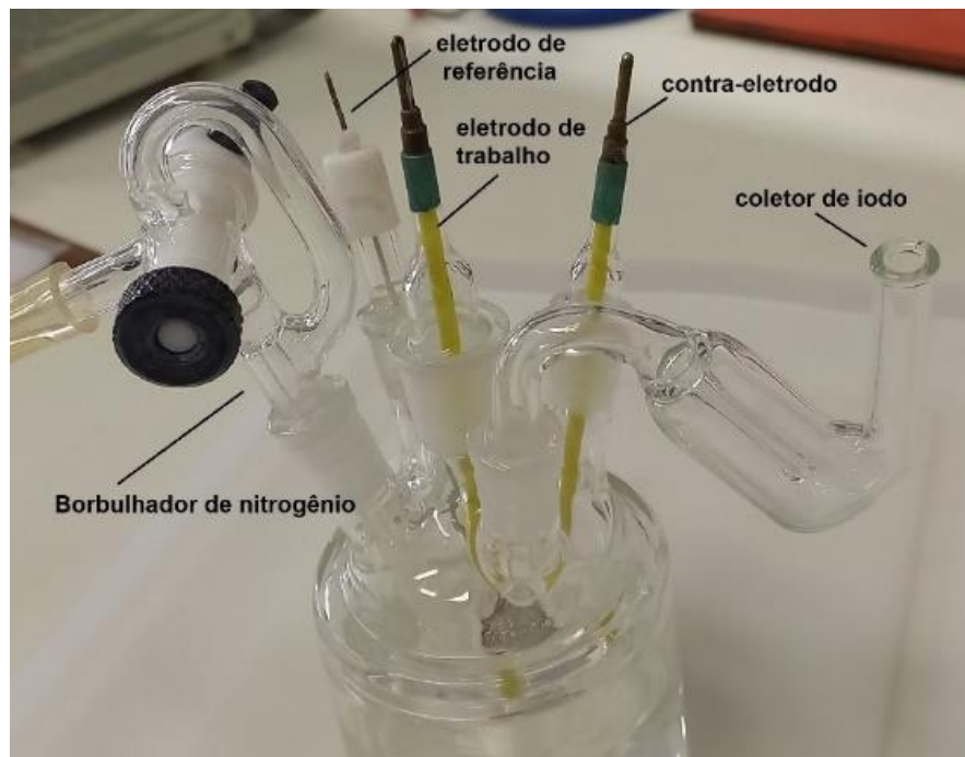
Figura 8 – Célula de 3 eletrodos utilizada para separação eletroquímica do iodo
