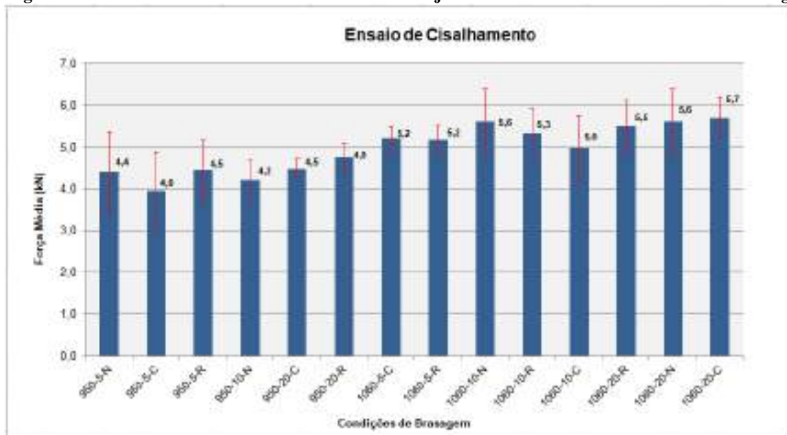
Figura 69 – Resultados dos ensaios de cisalhamento de juntas brasadas com massa de MA de 100 mg.
