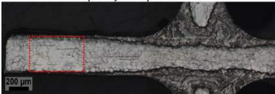
Figura 74 – Imagem panorâmica da junta, obtida por MO, da região da tira com grãos heterogêneos indicados pelo tracejado na temperatura de 1060 ^{\circ}\text{C} ENV.
