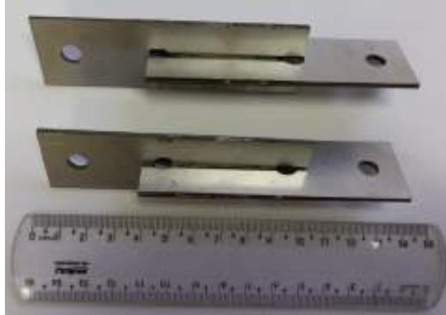
Figura 30 – Corpo de prova de cisalhamento da junta brasada simultaneamente com extensão.
