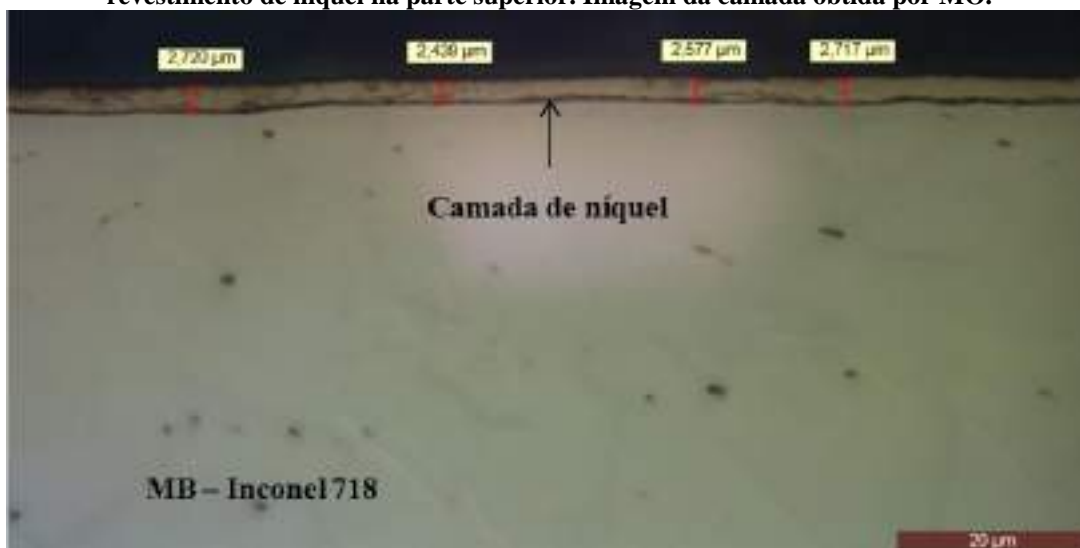
Figura 48 – Imagem obtida por MO da tira solubilizada pelo fabricante, como recebida, com revestimento de níquel na parte superior. Imagem da camada obtida por MO.
