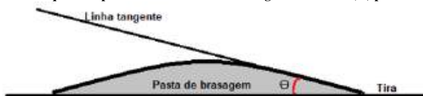
Figura 23 – Esquema representativo da medida do ângulo de contato ( \Theta ) por metalografia.
