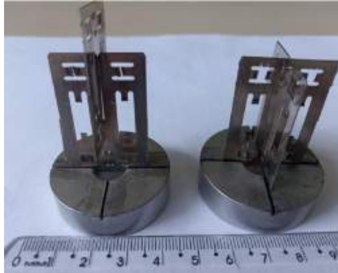
Figura 20 – Imagem do CP da junta posicionado no suporte antes da brasagem.
