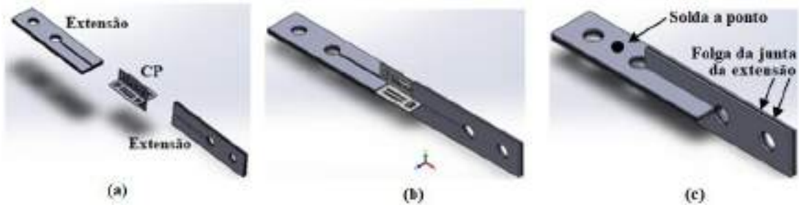
Figura 28 – Representação esquemática da fixação de CP na extensão para ensaio de cisalhamento, (a) vista explodida, (b) encaixe das extensões e (c) extensão indicando os pontos de fixação com MA na região da folga (indicada por setas).
