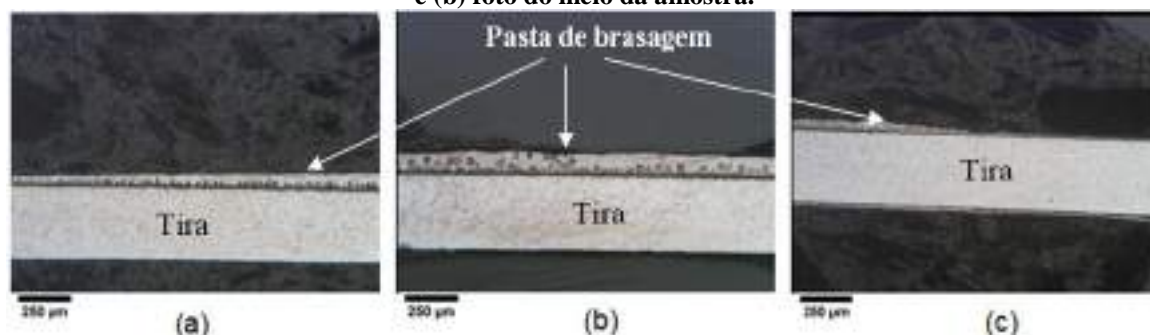
Figura 51 – Imagem obtida por MO indicando a molhabilidade do MA sobre a tira com revestimento de Ni, fundida em forno a vácuo, a 1060 °C e 10 minutos, (a) e (c) fotos das extremidades da amostra e (b) foto do meio da amostra.
