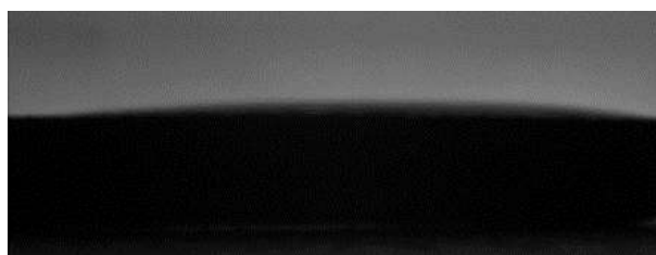
Figura 35- Imagem da análise de contato da amostra anodizada em solução aquosa 0,40 M \text{H}_2\text{SO}_4 por 8 h
