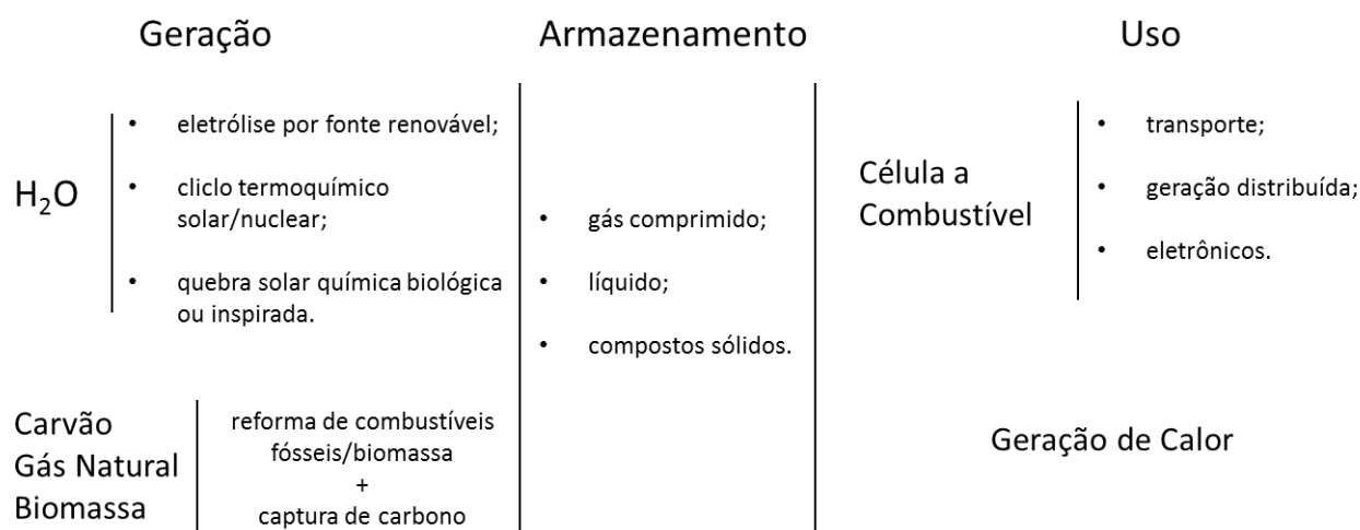
Figura 2 – Formas de geração, armazenamento e uso do hidrogênio
