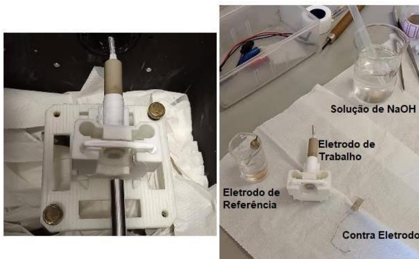
Figura 06 - Celula eletroquímica dentro da câmara do RAMAN.
