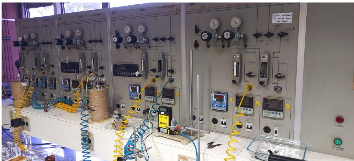
Figura 7 - Painel de testes para célula unitária Electrocell Laboratório do Centro de Células a Combustível (CCCH) IPEN – USP
