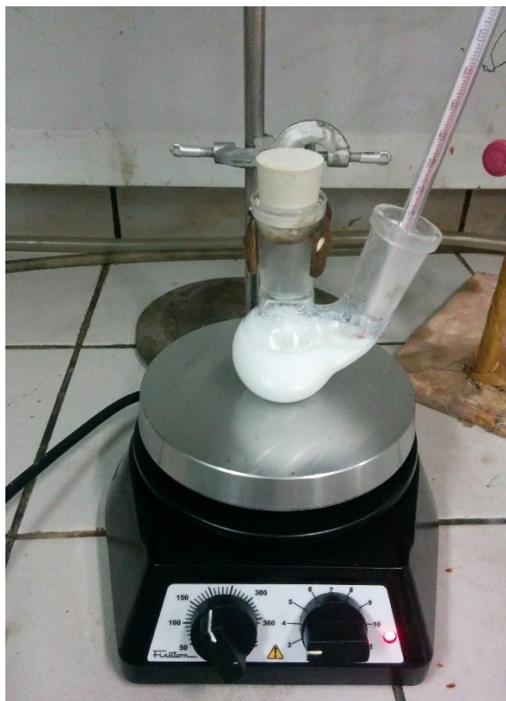
Figura 5 - Síntese das nanopartículas de óxido de Zinco
