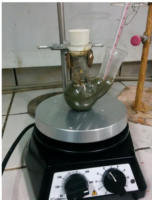
Figura 6 - Síntese das nanopartículas de dióxido de titânio com prata
