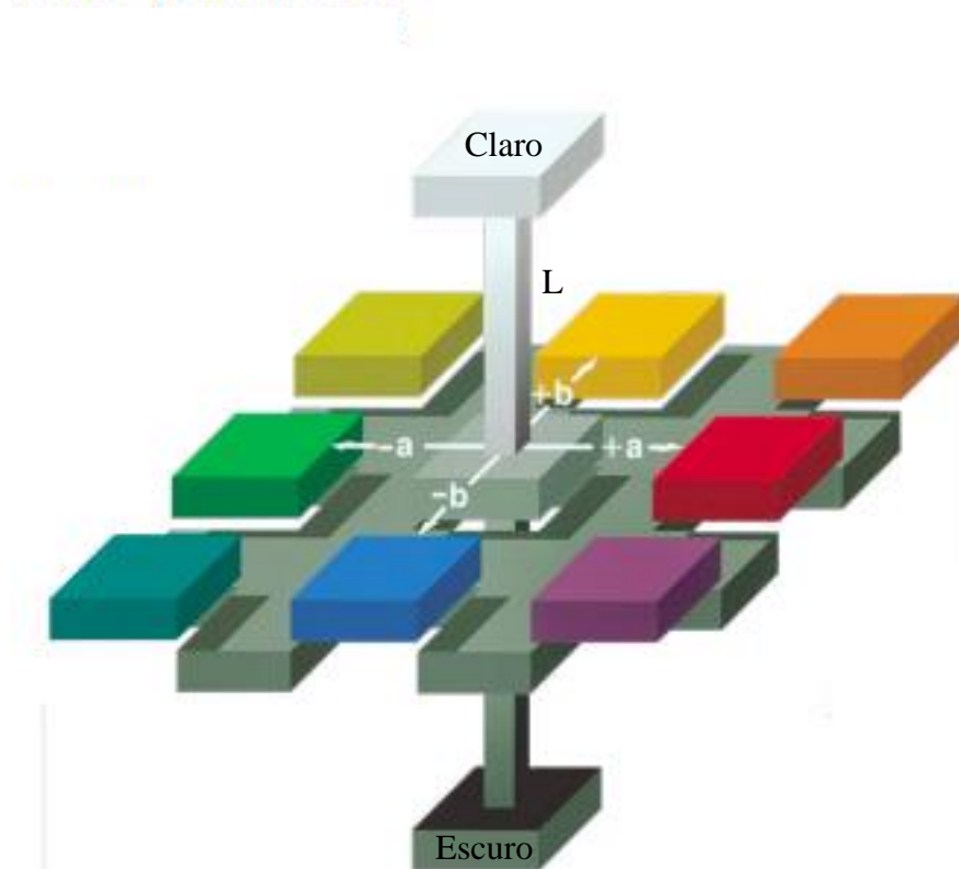
Figura 8- Significado geométrico das coordenadas L^*a^*b^* .
