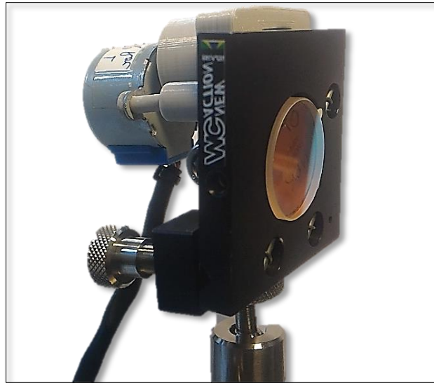
Figura 4.11 – Suporte para espelho acoplado com motor de passo 28BYJ-48. Fonte: próprio autor.
