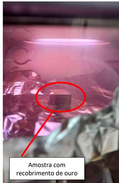
Figura 38: Processo de recobrimento com ouro no equipamento Leica Ace 200
