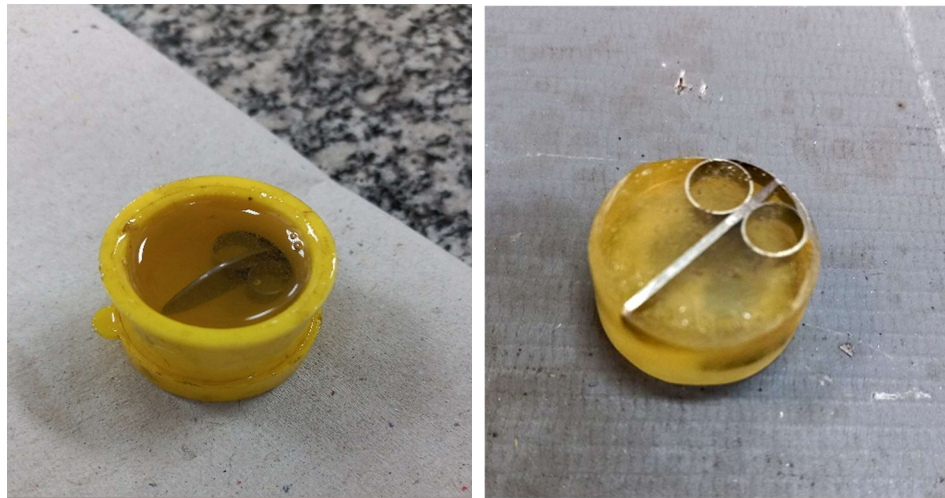
Figura 21: Imagem do processo no laboratório do CCTM do IPEN com embutimento da amostra irradiada em aço inox AISI 304. Posteriormente a retirada do recipiente plástico.
