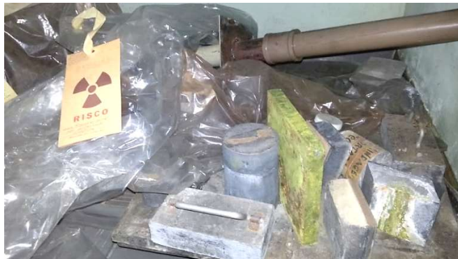
Figura 4: Blindagens Inutilizadas de chumbo devido contaminação no setor de radioquímica/radiofarmácia do IPEN.
