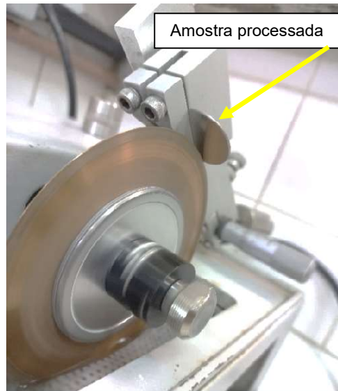
Figura 20: Processo de corte da amostra no equipamento Buehler Isomet.
