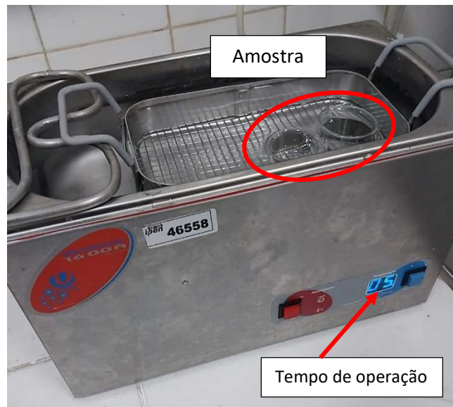
Figura 37: Preparação da amostra com limpeza no equipamento de ultrassom por 5 minutos
