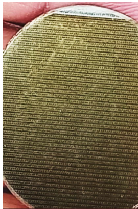
Figura 18: Aço inox AISI 304 irradiado para checagem inicial dos parâmetros.
