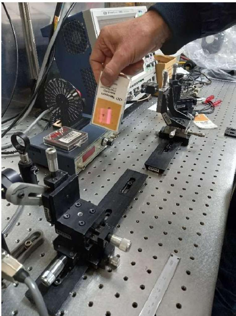
Figura 20 Detalhe da listra laser entre as lentes do telescópio e processos de focalização e colimação na área sensível do detector (ajuste e calibração para medição dos batimentos dos modos).
