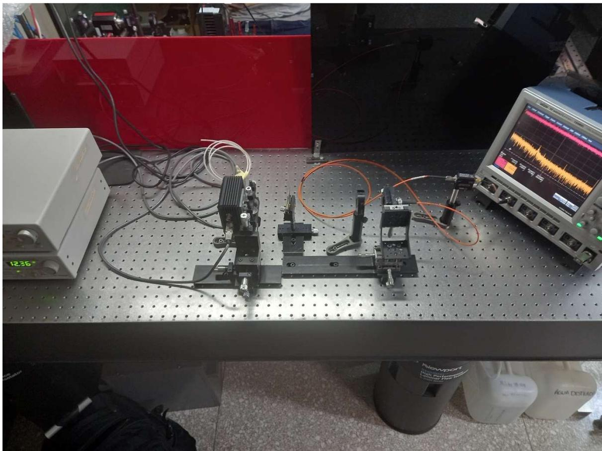
Figura 25 Montagem experimental incorporando a fibra óptica na etapa de saída do telescópio, arranjo preparado para a varredura das coordenadas transversais dos modos.
