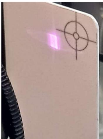
Figura 35 Efeito de dupla listra laser de ocorrência em campo distante cujo efeito é o aparecimento de dois picos de intensidade em função da coordenada transversal ( $x$ ) do diodo laser. (Imagem do autor)
