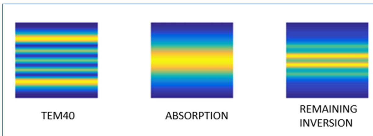
Figura 27 Esquerda: modo transversal TEM<sub>40</sub> dentro da região ativa de um guia de onda; Centro: absorção no caso de um bombeamento longitudinal por laser com qualidade gaussiana; Direita: inversão remanescente disponível para oscilação de outros modos.
