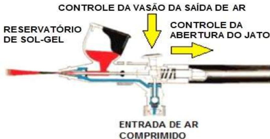
Figura 5 – Ilustração esquemática do aerógrafo de dupla função com reservatório lateral superior.
