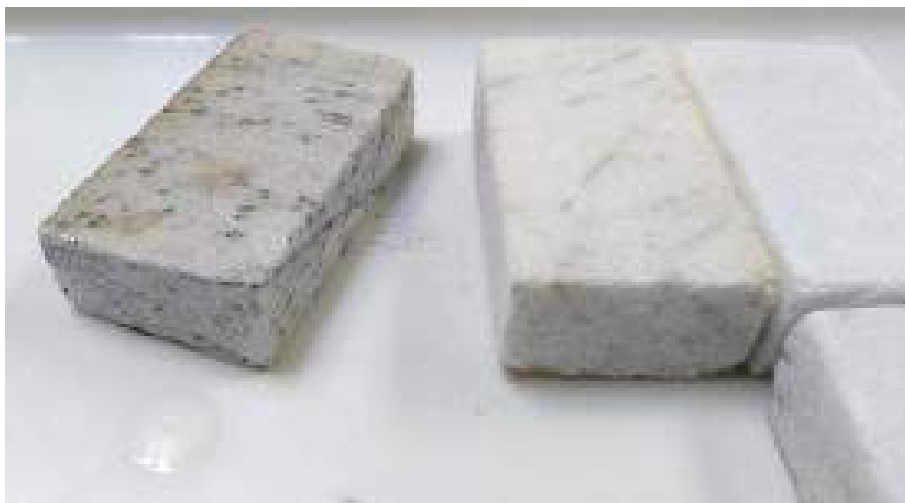
Figura 13 – Amostras da rocha mármore branco nacional, como recebido e com filmes bicamada e tricamada, aquecidas em mufla a 400 e 450 °C por 30' e submetidas à luz UVC por 60' e 300', para ensaio de absorção de água por capilaridade antes de pintar as laterais.
