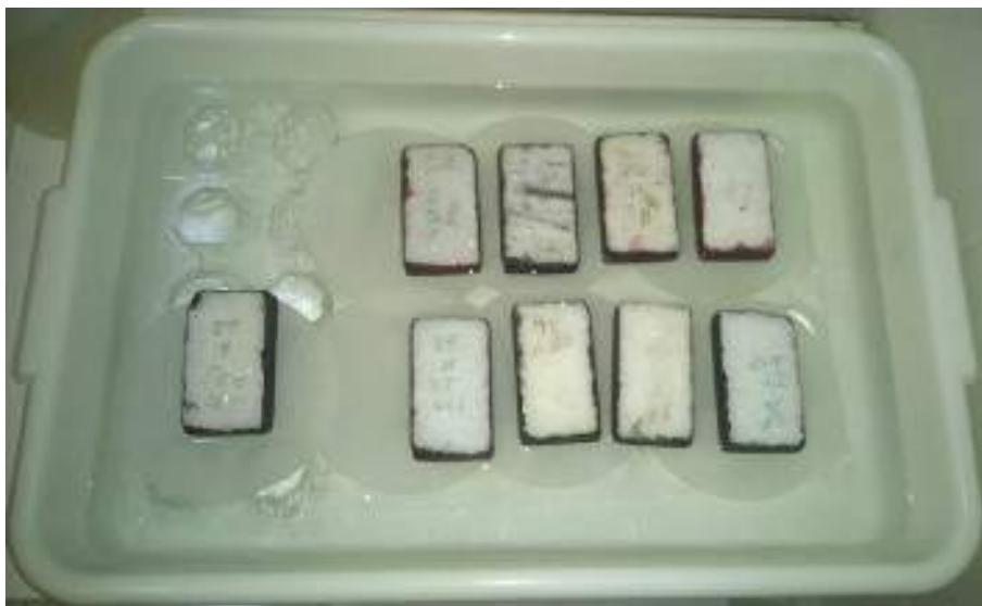
Figura 15 - Ensaio de absorção de água por capilaridade das amostras da rocha mármore branco nacional, como recebido e com filmes bicamada e tricamada, aquecidas em mufla a 400 e 450 °C por 30' e submetidas à luz UVC por 60' e 300'.
