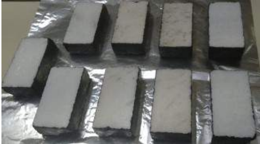
Figura 14 - Amostras da rocha mármore branco nacional, como recebido e com filmes bicamada e tricamada, aquecidas em mufla a 400 e 450 °C por 30' e submetidas à luz UVC por 60' e 300', para ensaio de absorção de água por capilaridade, após pintar as laterais.
