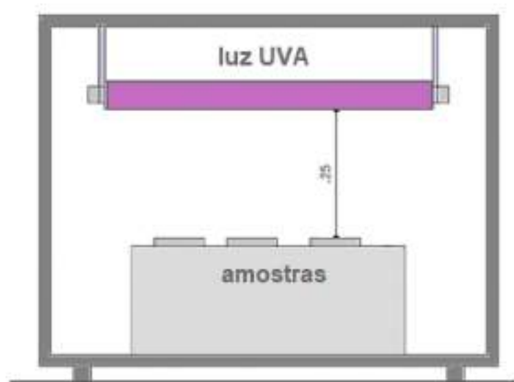
Figura 17 – Representação esquemática do reator fotocatalítico.
