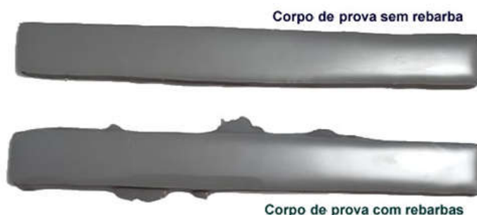
Figura 29 - Comparação de corpos de prova com e sem rebarba
