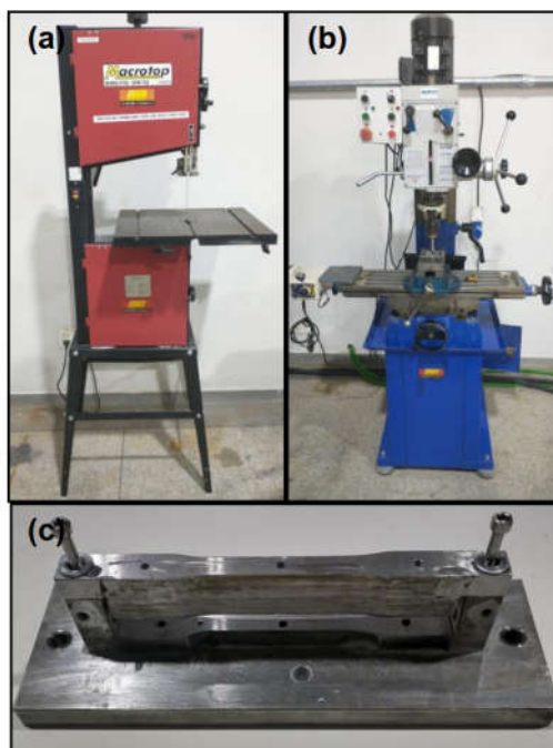
Figura 21 - Serra (a), fresadora (b) e máscara (c) utilizadas na usinagem dos corpos de prova
