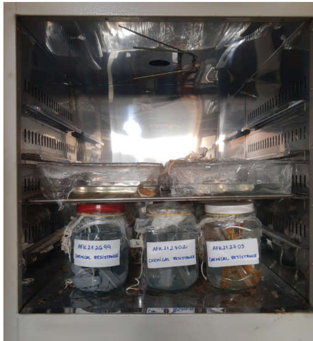
Figura 42 - Forno com temperatura controlada para armazenamento dos corpos de prova
