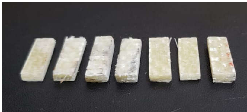
Figura 25 - Corpos de prova do compósito GRFPO para ensaios térmicos
