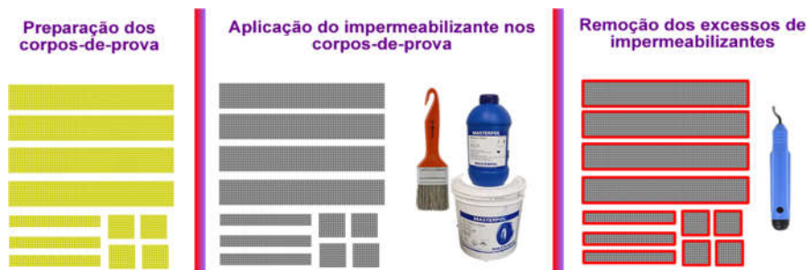
Figura 26 – Etapas de impermeabilização dos corpos de prova
