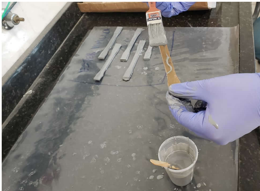
Figura 27 - Aplicação do impermeabilizante com pincel
