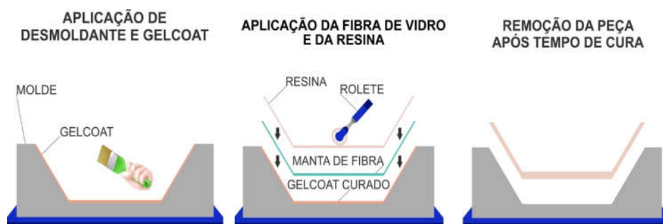
Figura 19 – Etapas do processo de hand lay-up
