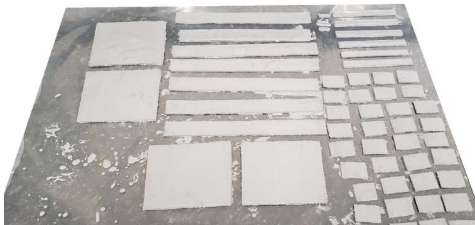
Figura 28 – Corpos de prova após receber a primeira demão de impermeabilizante
