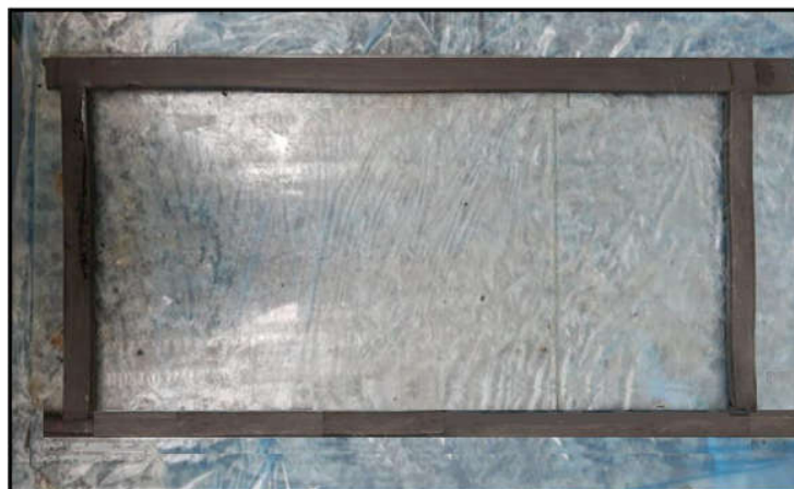
Figura 20 - Molde de vidro utilizado na produção das placas de compósito
