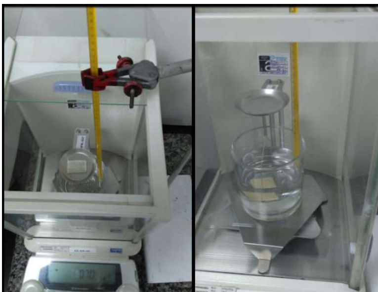
Figura 40 - Equipamento utilizado para o ensaio de densidade
