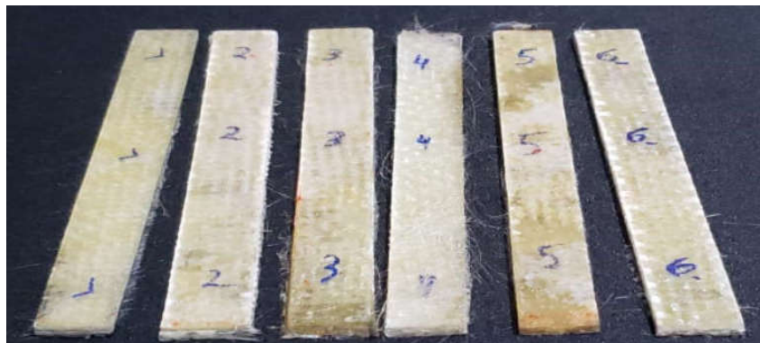
Figura 24 - Corpos de prova do compósito GRFPO para o ensaio de flexão
