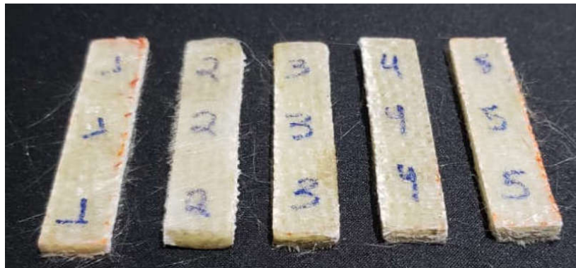
Figura 23 - Corpos de prova do compósito GFRPO para o ensaio de impacto
