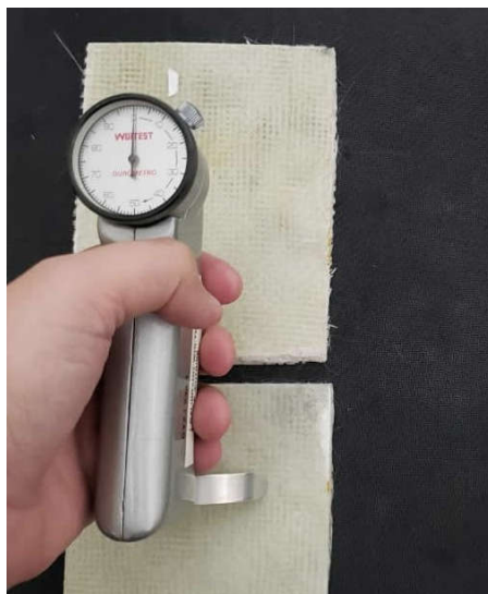
Figura 37 - Posicionamento do durômetro Barber Colman GYZJ 934-1 para determinação da dureza Barcol
