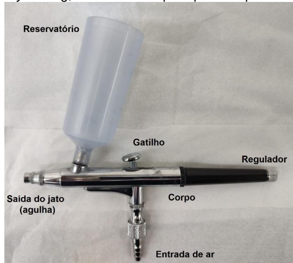
Figura 23 – Ilustração esquemática de um aerógrafo utilizado no processo de deposição de filmes a partir da técnica de spray coating , destacando os principais componentes presentes na pistola.
