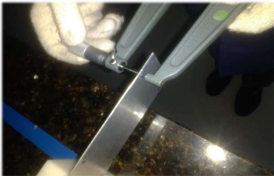
Figura 29 – Medição da espessura das placas combustíveis no CECON-IPEN
