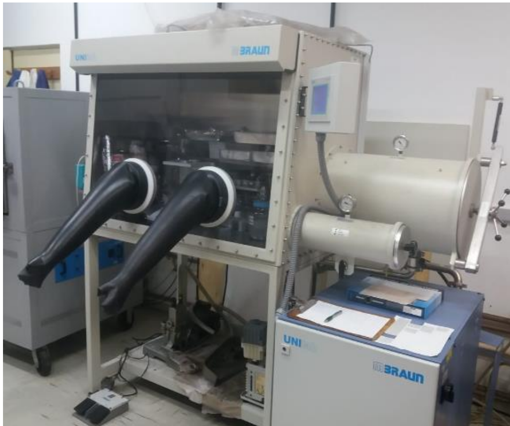
Figura 10 – Caixa de luvas com atmosfera de argônio purificado
