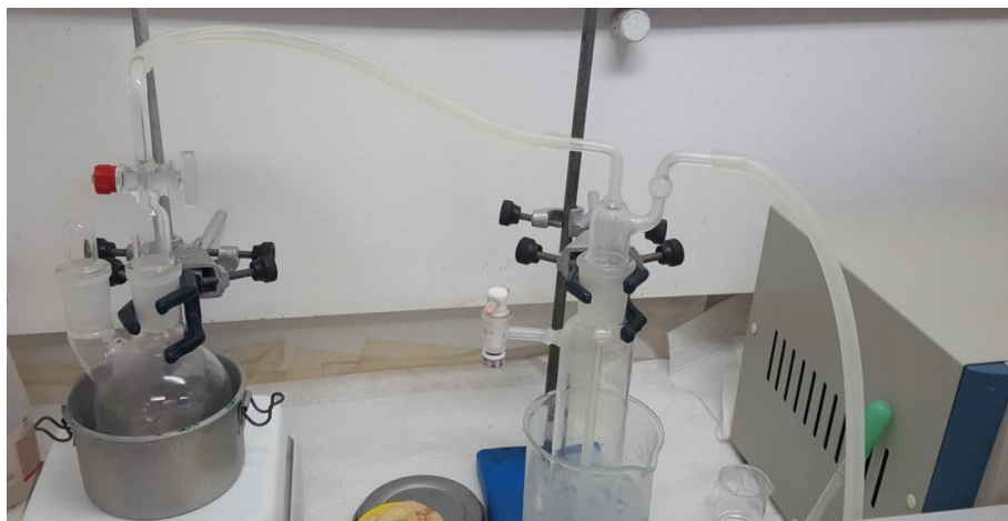
FIGURA 8: Equipamentos e esquema montado para evaporação de ácidos evitando a contaminação da bomba de vácuo.
