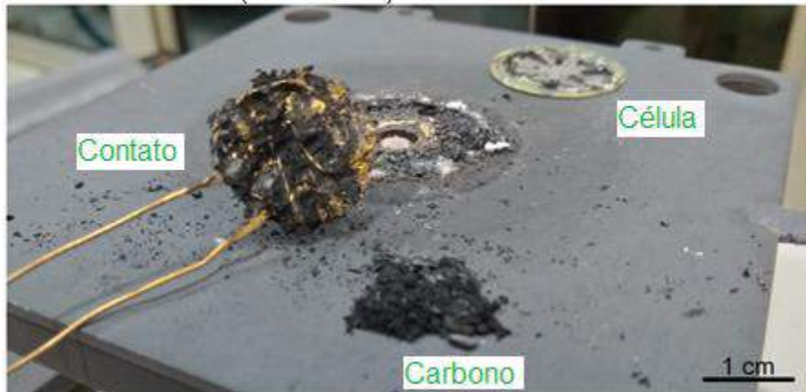
Figura 32 - Imagem do suporte do sistema de medidas com a célula (ao fundo) o contato de ouro do sistema e o carbono formado (mais à frente).
