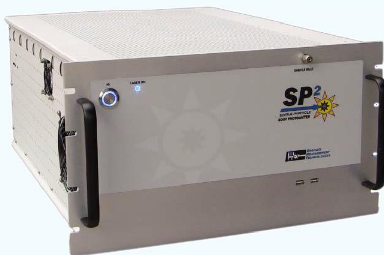
Figura 13 - Vista frontal do SP2 ( Single Particle Soot Photometer ), instrumento utilizado para obtenção da distribuição de tamanho do BC no sítio do ATTO na Amazônia.
