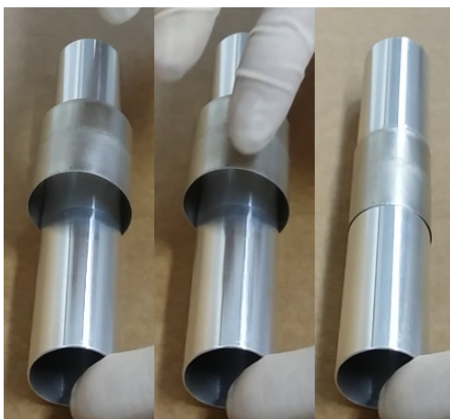
Figura 61- Encaixe da folha fina de urânio com eletrodeposição de níquel sobre o tubo interno do invólucro de alumínio
