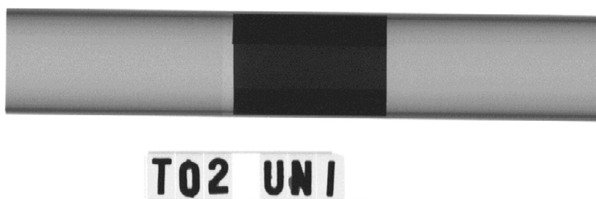
Figura 63- Raios x do alvo montado após expansão
