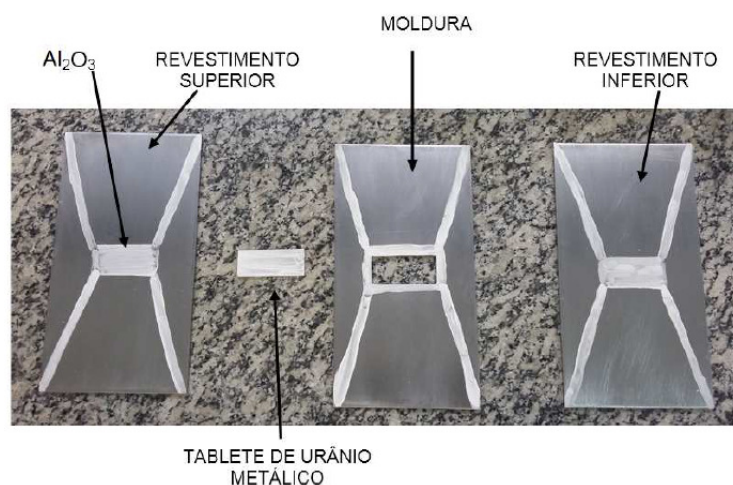
Figura 4- Conjunto de revestimento para laminação a quente antes de ser soldado
