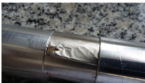
Figura 8- Rasgo na folha fina de níquel
