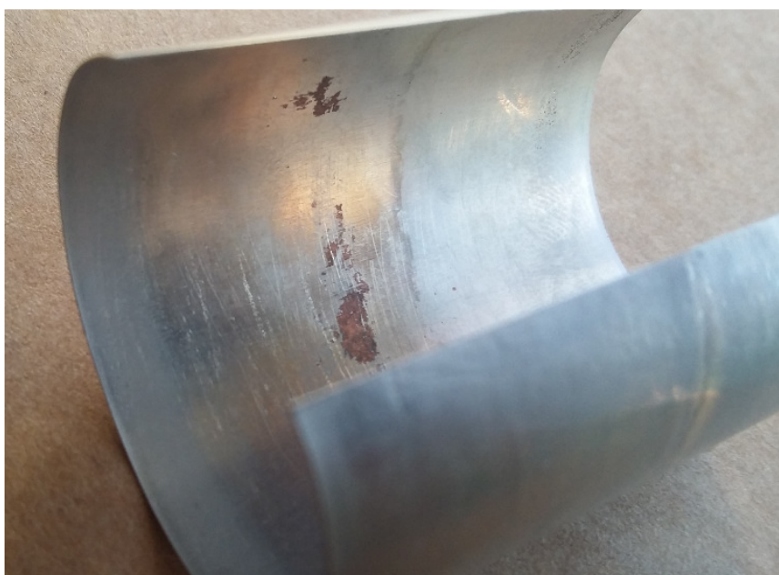
Figura 52- Falha na deposição no interior da folha fina
