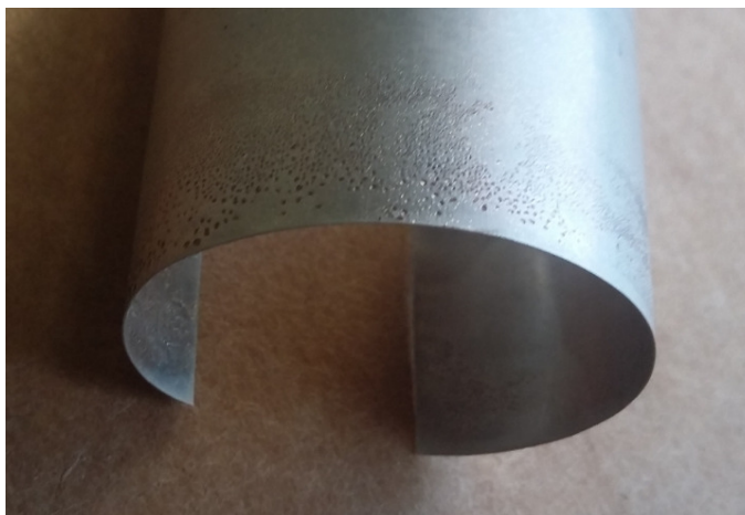
Figura 55- Defeitos na camada de níquel oriundas das bolhas de ar injetadas
