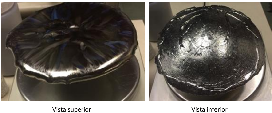
Figura 17 - Botão formado no forno de feixe de elétrons solidificado no cadinho de cobre refrigerado a água. Vistas superior e inferior.
