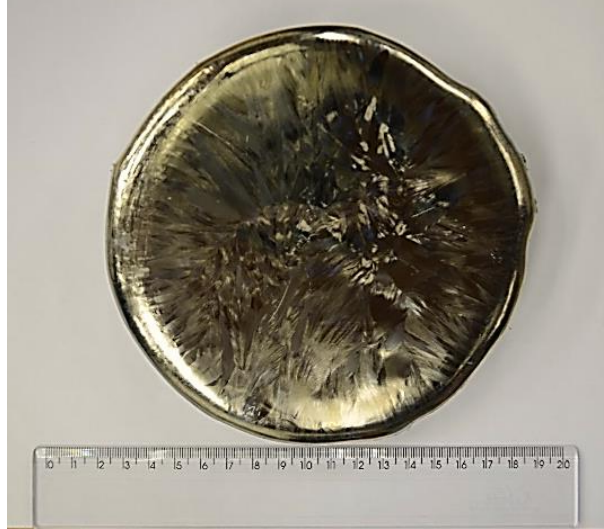
Figura 35 - Botão da liga Ti13Nb13Zr após quatro fusões.
