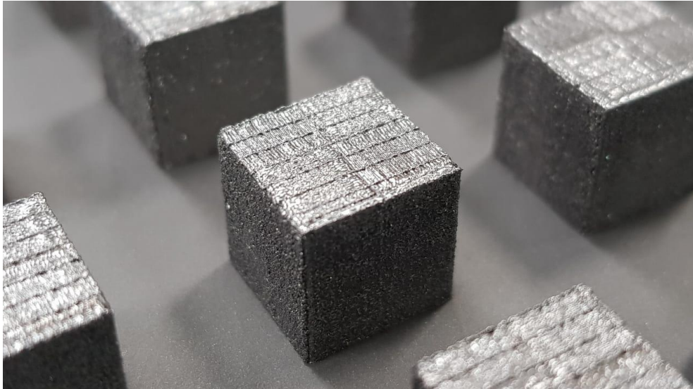
Figura 66 - Detalhamento de um corpo de prova mostrando a estratégia de varredura do feixe de laser na peça produzida com pó HDH.
