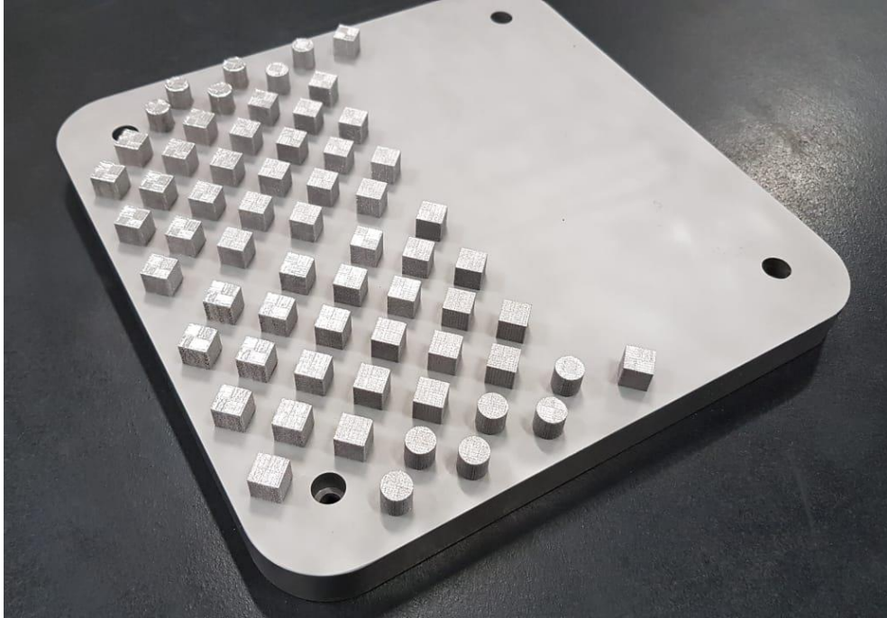
Figura 65 - Experimento de definição de parâmetros potência e velocidade do feixe de laser, com réplicas para o pó HDH.
