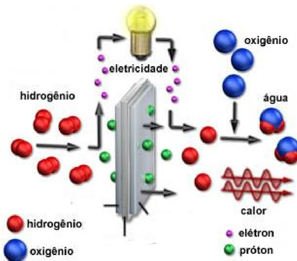
FIGURA 2: Modelo básico de uma célula a combustível 21
