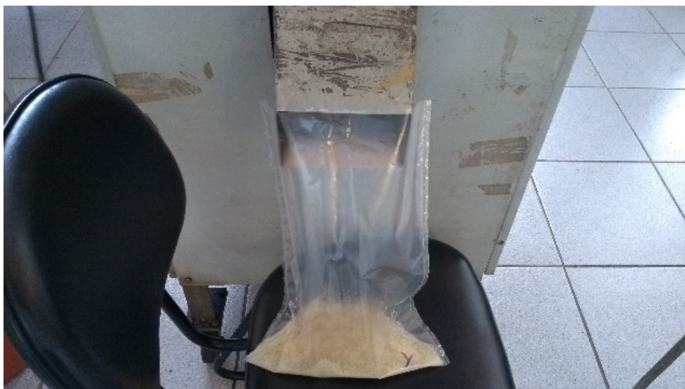
Figura 6 – Grânulos finais - pellets do nanocompósito de Polipropileno com \text{CaCO}_3/\text{AgNP}
