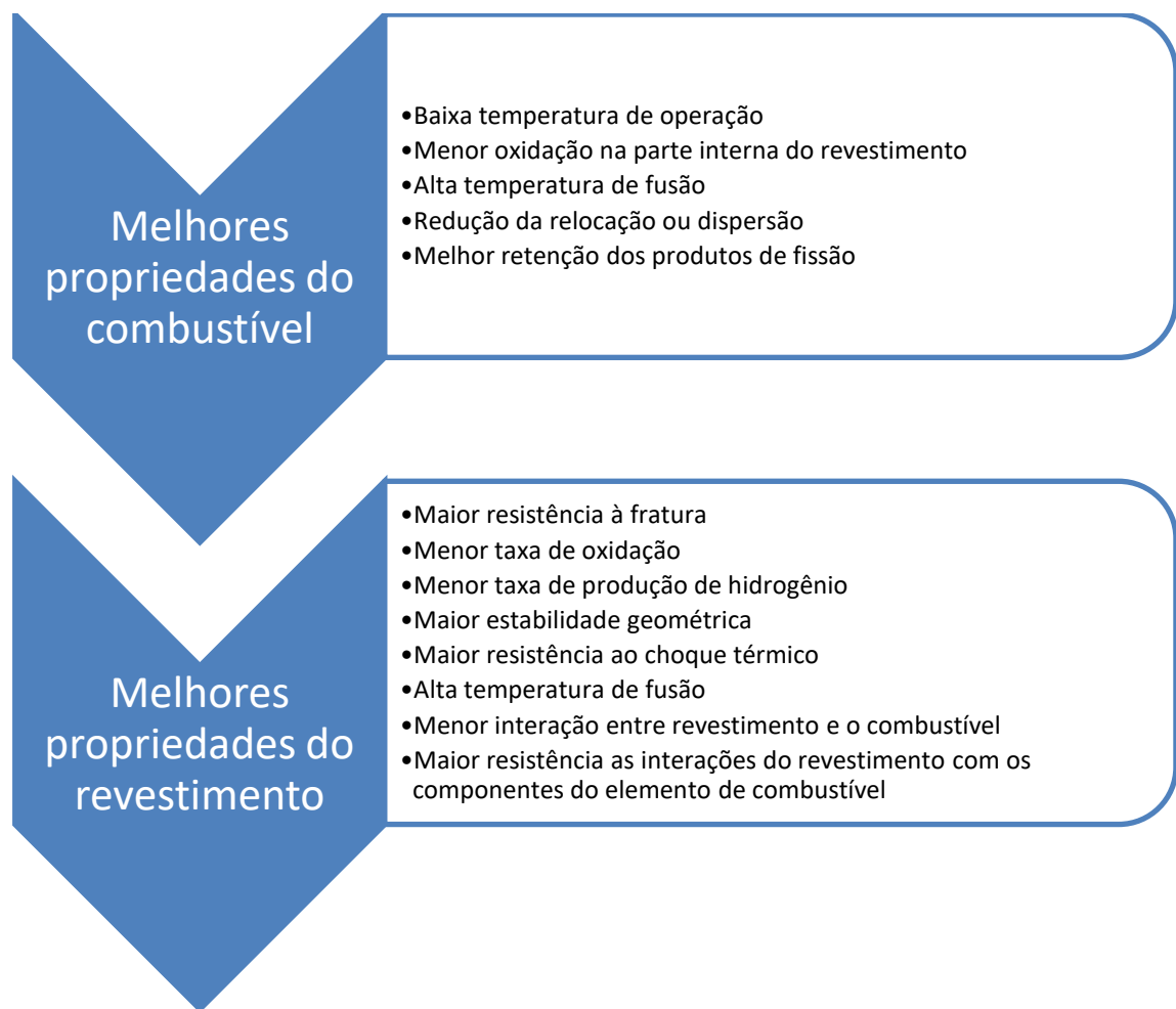
Figura 1.1 - Resumo das características e requisitos desejáveis para combustíveis tolerantes a falha.
