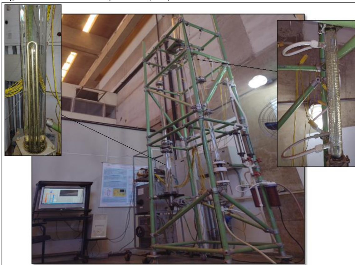
Figura 12 – Circuito de Circulação Natural (CCN)
