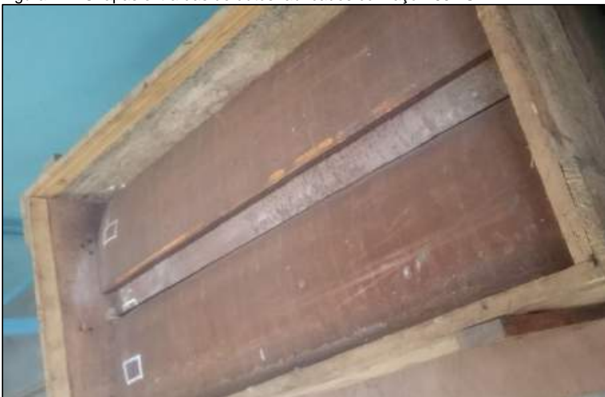
Figura 24 - Chapas extraídas de dutos fabricados com aço X65MS
