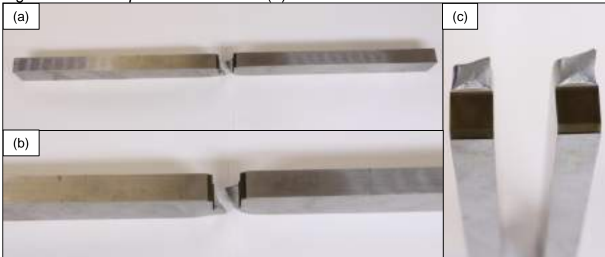
Figura 88 - Fotos post mortem do SE(T) c P02
