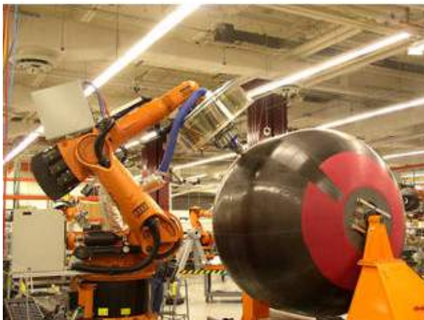
Figura 9 – Vaso de pressão esférico produzido por AFP.
