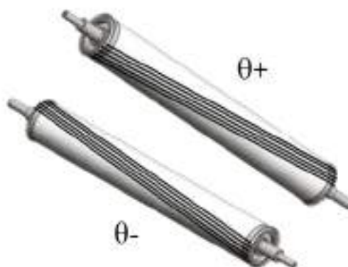
Figura 14 – Camadas helicoidais superpostas \pm\theta .
