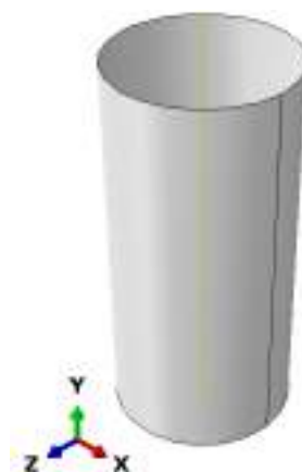
Figura 28 – Criação do cilindro em casca.
