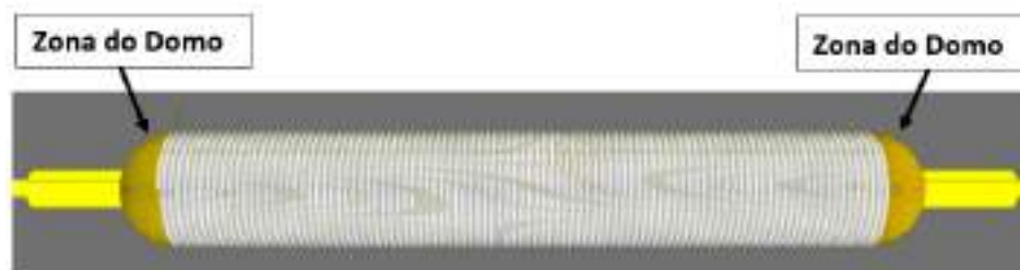
Figura 10 – Disposição da camada circunferencial em um mandril de fabricação.
