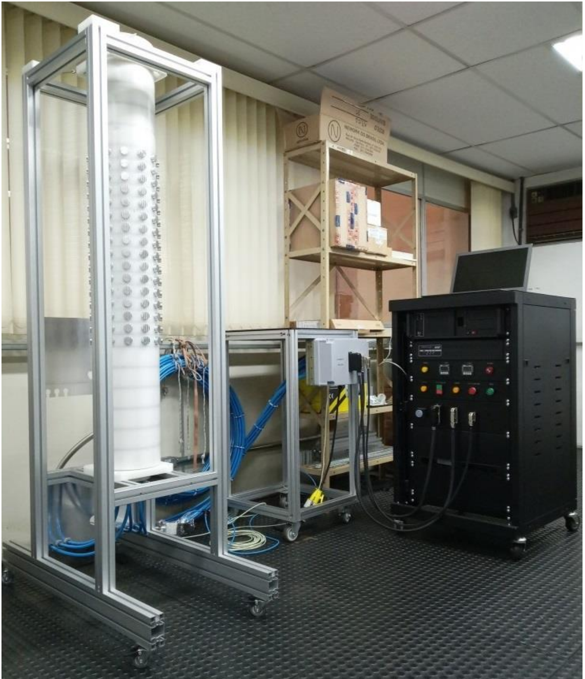
Figura 3.3 – Vaso de medição do calorímetro (à esquerda) e gabinete de controle (à direita).
