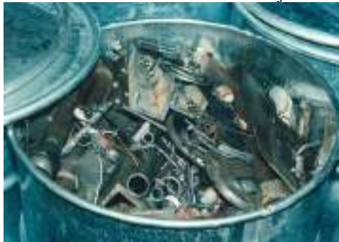
Figura 37 - Tambor de 200L armazenando rejeitos radioativos
